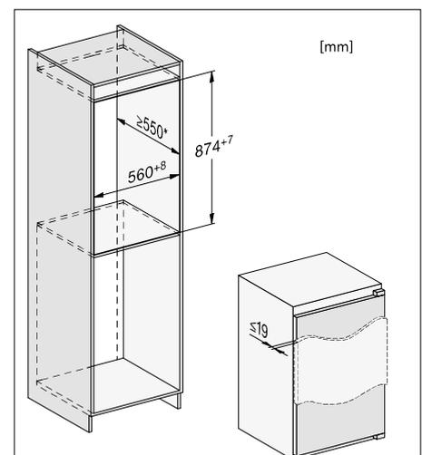
\* Der deklarierte Energieverbrauch wurde mit einer Nischentiefe von 560 mm ermittelt. Das Kältegerät ist bei einer Nischentiefe von 550 mm voll funktionsfähig, hat aber einen geringfügig höheren Energieverbrauch.
